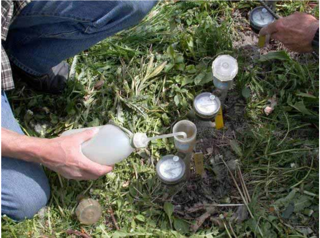
Abbildung 14: Platzierung und Füllung des Tensiometers
