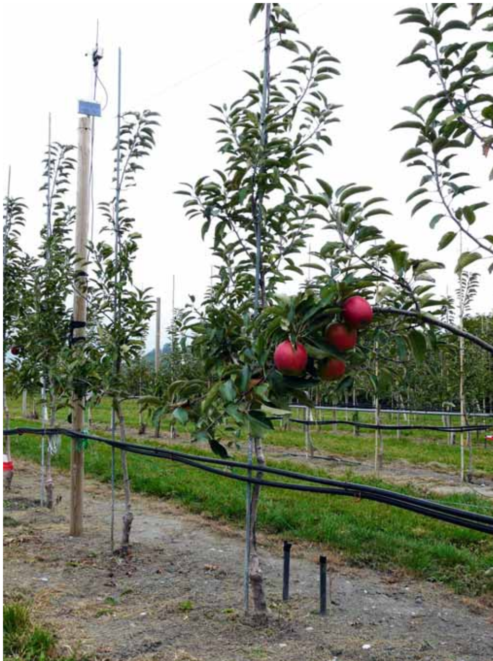
Abbildung 18: Radiosender verbunden mit sechs Watermark® Sonden
