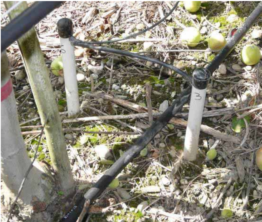
Abbildung 15: Ein paar Watermark®-Sonden, die eine Einheit bilden und die Steuerung der Bewässerung ermöglichen. Die horizontale Distanz zum Tropfer beträgt hier 30 cm mit Tiefen von 30 und 60cm.
